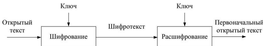
Рисунок 3 – Шифрование и расшифрование с одним ключом
